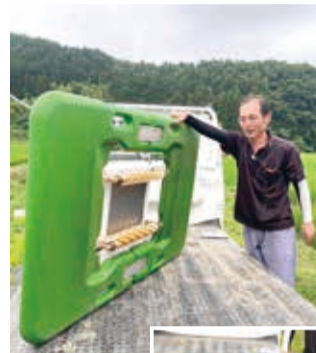
草取り用のアイガモロボット。水平にして田んぼの中で動かします
